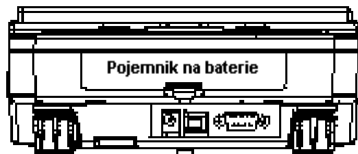
Rys. 4 Tył wagi z pojemnikiem na baterie
